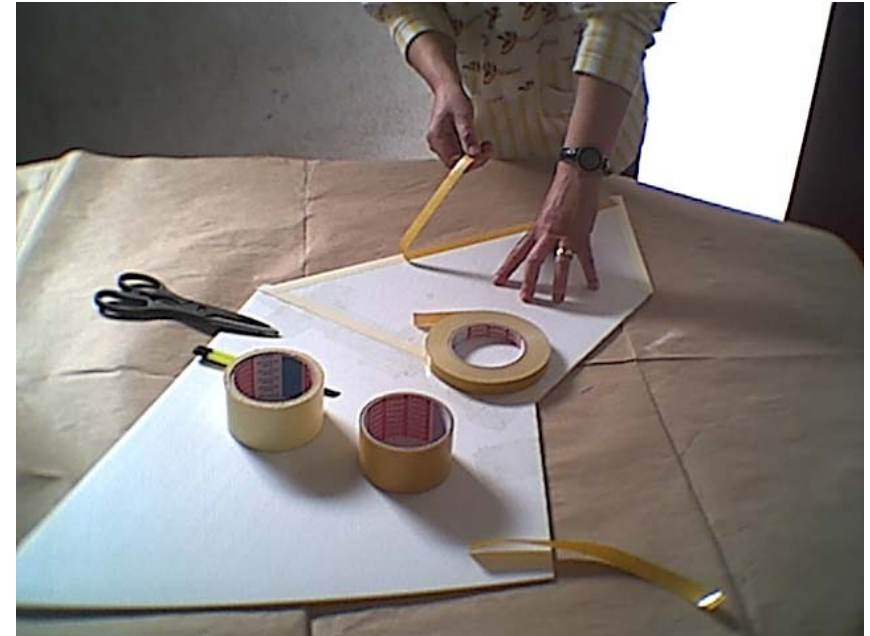
Colocação da fita-cola de dupla face nas extremidades, para fixação do papel reflector
