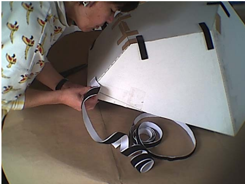
Colocação do BELCRO autocolante de união entre as partes
