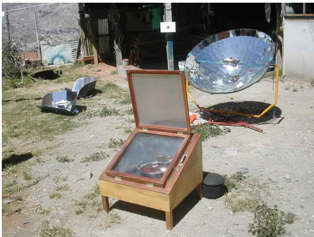
Foto 9. Varias cocinas solares: Tipo panel (izq.), caja ULOG (centro), y Sk-14 parabólica (der.).
